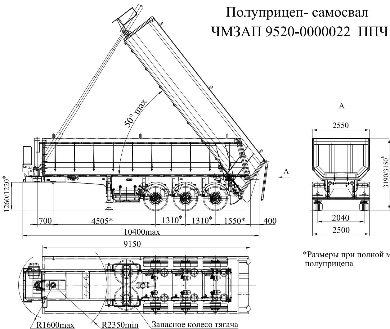
\*Размеры при полной массе полуприцепа
