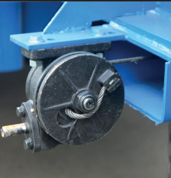
Стабилизатор подъёма кузова, боковая съемная защита, лебедка для запасного колеса
