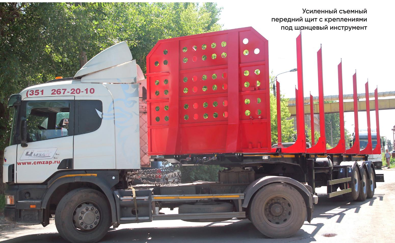
бедка для увязки груза, инструментальный ящик, корзина запасного колеса, передний щит, боковая защита, оси – всё это комплектующие ПАО «Уралавтоприцеп». К тому же конструкция полуприцепа-сортиментовоза допускает широкий выбор вариантов комплектации и исполнения полуприцепа.
